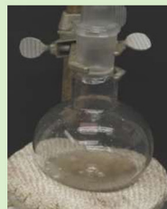
Додавання манган карбонат та діетиленгліколь. Почати підігрівати
