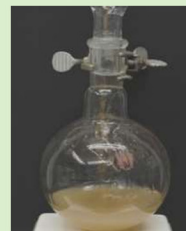
Додавання касторової олії та толуїлендиізоціанату
